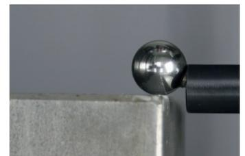
Breiter Anwendungsbereich: wählen Sie zwischen zwei Schaftdurchmessern  $\varnothing 18$  und  $\varnothing 25$ . Der Tiefbohrtester wird über den Schaft direkt in der Bohrbuchse / -Spindel aufgenommen.
