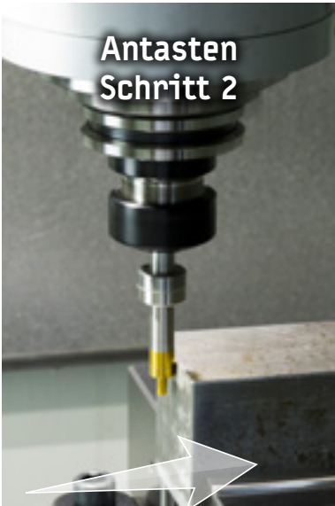
2. Durch langsames und vorsichtiges Anfahren des rotierenden Kantentasters (ca. 500 1/min.) an die entsprechende Bezugs-kante wird die oszillierende Bewegung stetig geringer.
