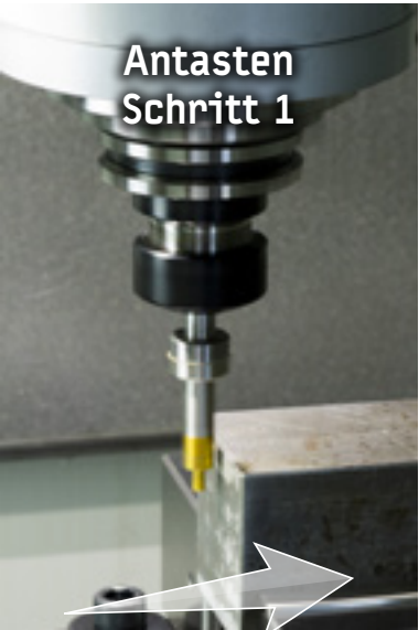
1. Das Unterteil des Kantentasters lässt sich durch leichten Fingerdruck aus der Achsmitte schieben und läuft unrund.
