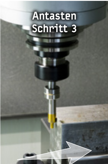
3. Bei Erreichen der Position weicht das Unterteil entlang der Kante aus. Die Position entspricht nun dem Radius des Tastkopfes.
