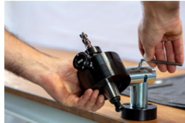
Das Montagegerät ist in den Größen SK30, SK40, HSK63 sowie VDI25, VDI30 und VDI40 erhältlich. Weitere Größen sind auf Anfrage verfügbar.
