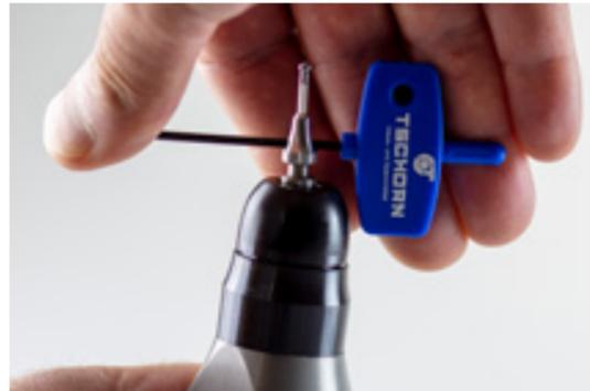
Leichtes Ein- und Ausschrauben der Tasteinsätze dank praktischer Bohrung.
