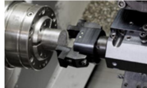
Positionieren Sie den Stangengreifer in Z-Richtung vor der Stange.
