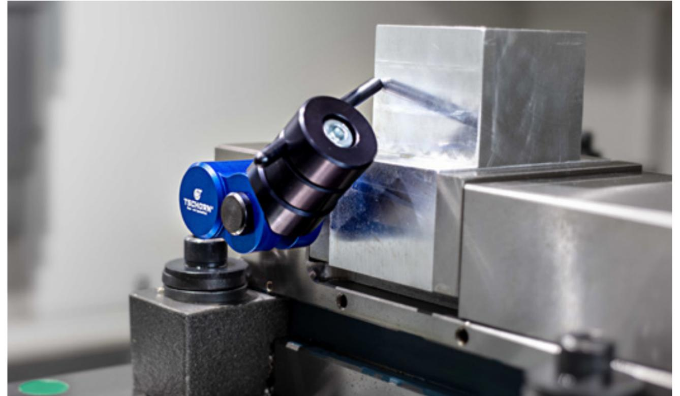
Der Werkstückanschlag wird mittels Magneten direkt am (z.B.) Schraubstock angebracht und dient dem exakten Positionieren von Werkstücken.
