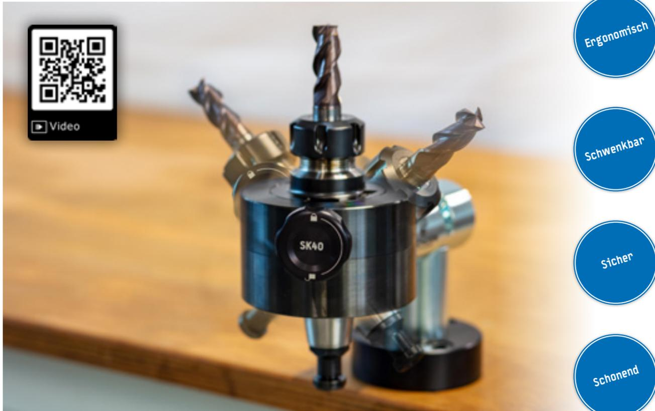
Montagegerät mit Werkzeugaufnahme aus Stahl zum **schonenden Einspannen** Ihrer Werkzeughalter. Dank einzigartiger Technologie wird der Werkzeughalter nicht am präzisen Konus gespannt sondern der Konus liegt frei. Dies schont nicht nur Ihre Werkzeughalter, sondern sichert auch eine **präzise Bearbeitung** Ihrer zu fertigenden Teile.
