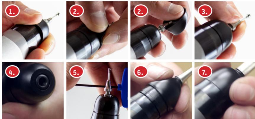
1. De afdichting voorzichtig uit de groef trekken.
